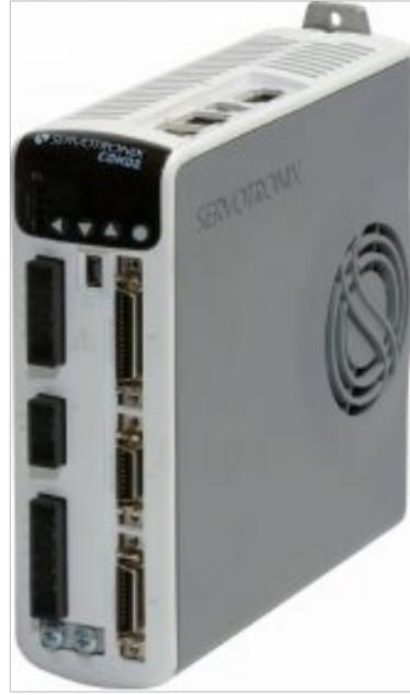
通电后高创伺服系统不转有嗡嗡声的处理方法：1. 故障原因①转子绕组有断路（一相断线）或电源一相失电；②绕组引出线始末端接错或绕组内部接反；③电源回路接点松动，接触电阻大；④电动机负载过大或转子卡住；⑤电源电压过低；⑥小型电动机装配太紧或轴承内油脂过硬；⑦轴承卡住。2. 故障排除①查明断点予以修复；②检查绕组极性；判断绕组末端是否正确；③紧固松动的接线螺丝，用万用表判断各接头是否假接，予以修复；④减载或查出并解决机械故障，⑤检查是否把规定的面接法误接；是否由于电源导线过细使压降过大，予以纠正，⑥重新装配使之灵活；更换合格油脂；⑦修复轴承。
